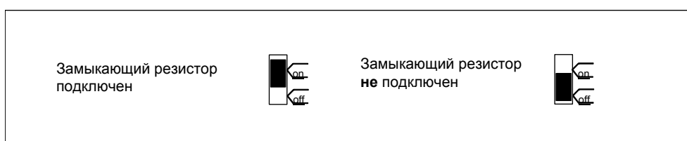
Рис. 5–12. Подключение замыкающего резистора
